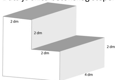
Koliko je potrebno  $dm^3$  betona da se napravi ovo stepenište?
